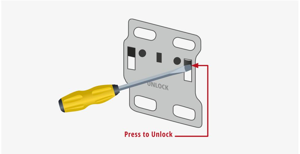
**11** • Mit einem Schraubendreher können Sie die Aushängesicherung wieder lösen.
