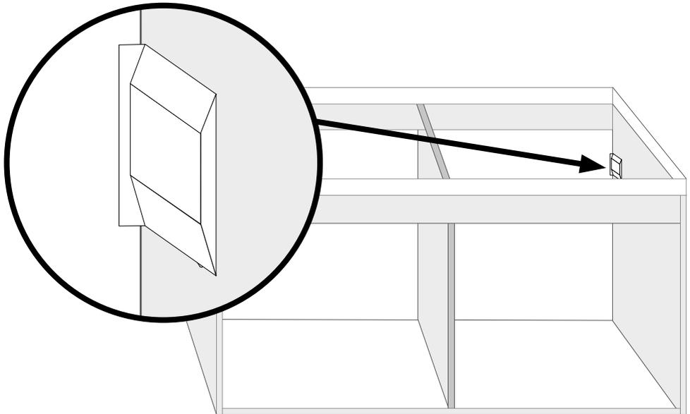
**12** • Decken Sie mit den Abdeckplatten die Aufhängebeschläge ab.
